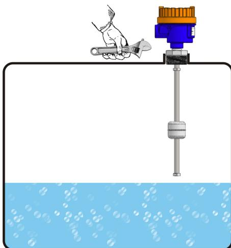
**MONTAGEM EXTERNA/INTERNA - Conexão ao processo: 1/4" a 3/4"**
