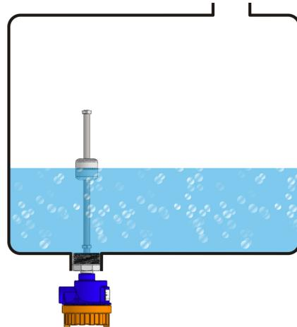
**MONTAGEM EXTERNA - Conexão ao processo: 1"**
