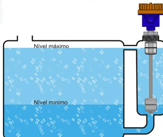
**MEDIDOR EM PESCOÇO NO TANQUE**
